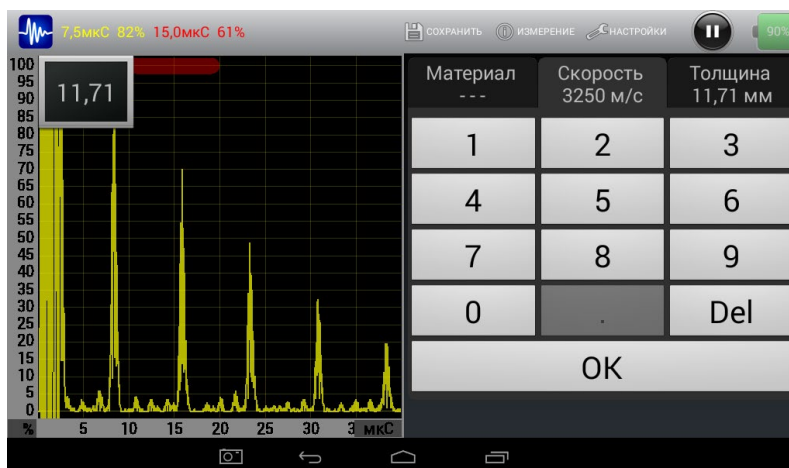
Рис. 21. Калибровка с заданием скорости звука
