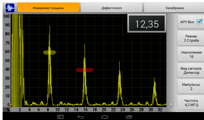
Рис. 16. Выбор между измерением толщины, режимом дефектоскопа и режимом калибровки
